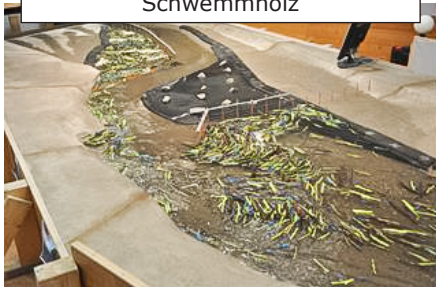
5 Holzrechen für Rückhalt von Schwemmholz
